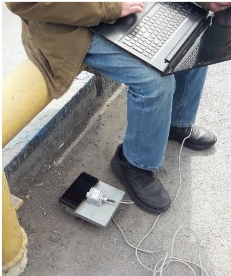
Նկար 28: JHG-DQ1 BS004 տատանաչափ կամրջի տատանումների գրանցման պահին:
